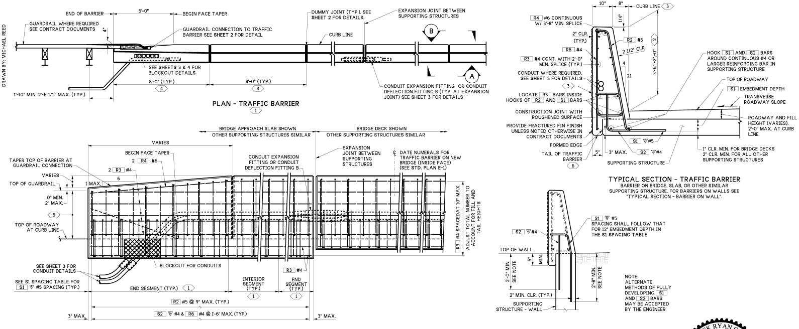
OUTSIDE ELEVATION - END OF TRAFFIC BARRIER
