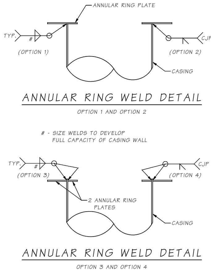
Figure 7.10.6. CFT Weld Detail
